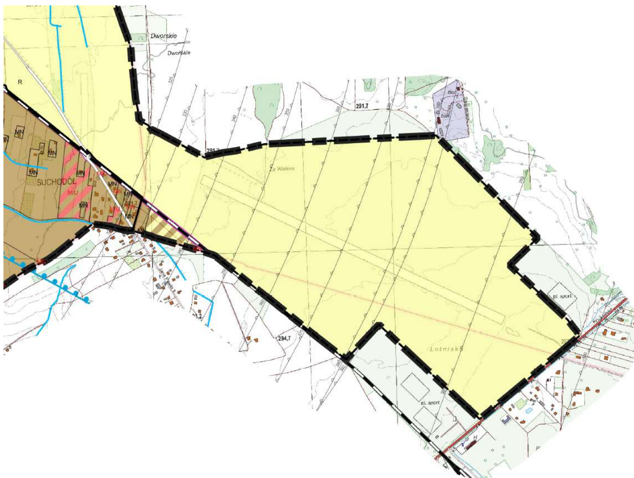
Ryc. Granice powierzchni ograniczających przeszkody dla lotniska Krosno (wniesienie obiektu w metrach n.p.m.) – Uwarunkowania zagospodarowania przestrzennego
