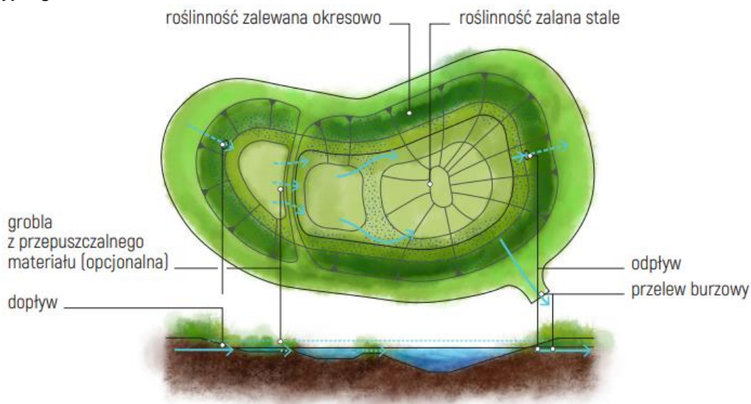
Rysunek 45. Schemat typowego stawu retencyjnego, widok z góry i przekrój
