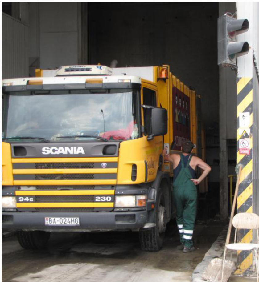
Rysunek 9: Proces rozładunku odpadów do bunkra.
